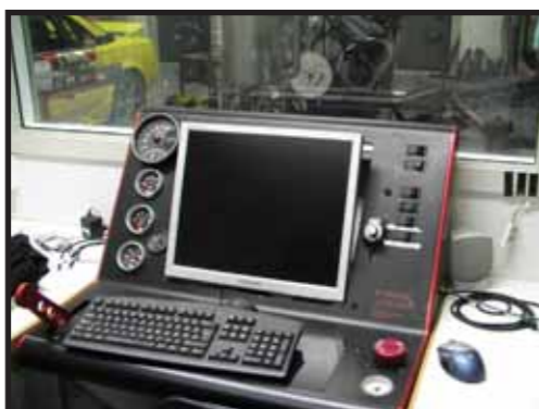
Kontrollrommet til motorbremsbenken og "den rullende landeveien". Polly Motorsport har "rullende landevei" for å måle effekten, eller de kan bremse motoren i benk.
