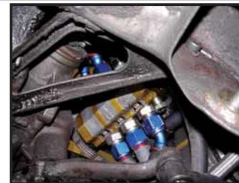
4-steps oljepumpe som sørger for trykksmøring av motoren. Oljen hentes fra et eget reservoar og pumpes inn i motoren. Bunnpannen virker som et oppsamlertrau der oljen suges tilbake til oljereservoaret som er montert i bilen.
