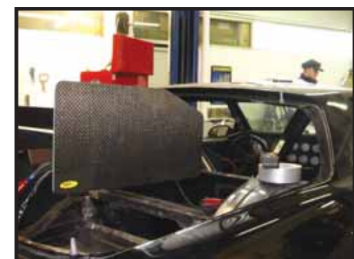
En av de få tingene som utvendig vil skille bilen fra det originale. En airfoild, eller vinge, for å forhindre at bilen blir "løs i rumpa" som det heter når man passerer 300 km/t.
