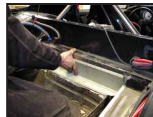
Bagasjerommet blir ombygd for å få med seg nok bensin til rekordforsøket. Bensin er et kritisk punkt. Polly'en må ha med MYE bensin. Av sikkerhetsmessige grunner benytter man stålbygde bensinblærer med sikkerhetsskum i.
