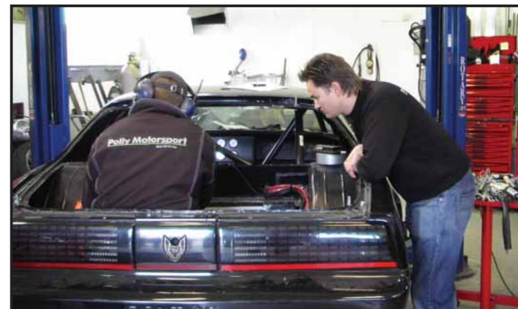
Bagasjerommet blir ombygd for å få med seg nok bensin til rekordforsøket. Bensin er et kritisk punkt. Polly'en må ha med MYE bensin. Av sikkerhetsmessige grunner benytter man stålbygde bensinblærer med sikkerhetsskum i.
