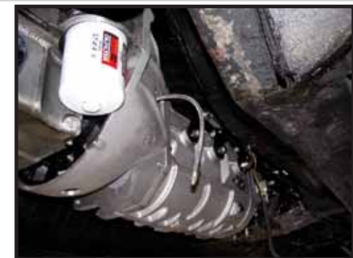
Spesialbygget Richmond 6-trinns gearkasse fra Tex Racing er montert sammen med ny Quatermaster clutch. Polly'en har kjørt automat til nå. Det tør han ikke på Silver State Challenge, på grunn av de ekstreme belastningene.
