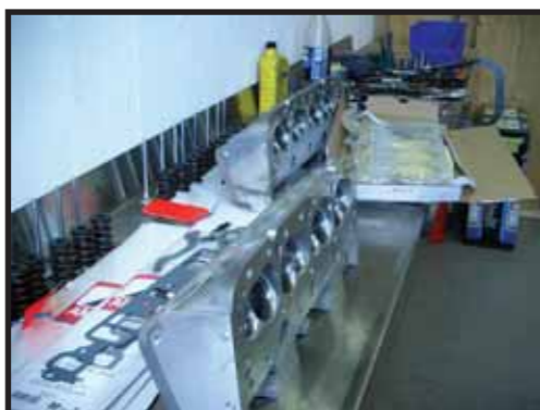
Nye topper! Polly Motorsport har flowbenk. Og det er stort sett ingen topper som monteres uten at de er bearbejdet på ett eller annet vis.
