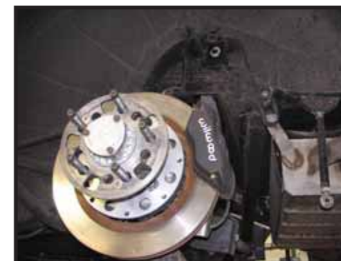
Store bremses og spesialnav må benyttes på en bil som skal kjøre så fort og så lenge som det Polly'en og hans Firebird har planlagt.
